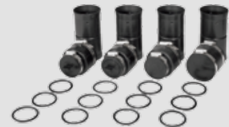
MSH-Zubehör-Set 4 zur erdseitigen Abdichtung. Bestehend aus: • 4x Manschettenstopfen - 2x MS 75-U 1/24-52 - 1x MS 75-KD 1/13-21 + 3/7-13 + 1/5-13 - Blind: MS 75-D/0 • 8x Edelstahl-Spannbänder • 4x Doppelmuffen (für Kabuflex DN75) • 12x Profildichtringe
