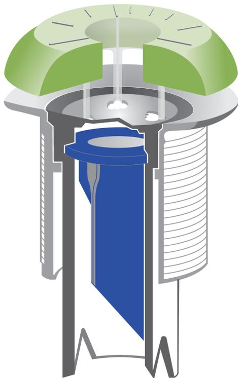
Das patentierte Key-System von Enswico wurde für den Einsatz in wasserlosen Urinalen entwickelt. Es ersetzt Wasser durch Technologie. Bei durchschnittlich 3 Key-Ventilen pro Jahr und Urinal spart das Key-System jährlich 80'000 bis 120'000 Liter Wasser.
