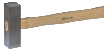
Hartmetall-Bossierhammer zum Bearbeiten von Naturstein. Beidseitig (diagonal) mit einer Hartmetall-Sprengisen-Platte.
