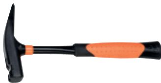
Stahlrohr-Latthammer BlackGiant mit 2-K-Kusto-Griff mit Sicherheitsstift und zusätzlichem, gehärtetem Innenrohr als Schutz des Stiels bei extremen Belastungen und für mehr Sicherheit in kritischen Arbeitsbereichen, Bahn geraut.
