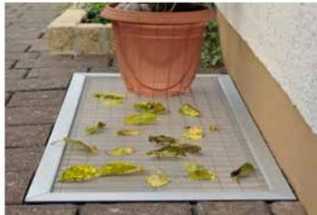
Mit Edelstahlgewebe V2A für Standardlichtschächte 60/80/100/125/150/200. Montage durch Verschrauben mit dem Gitterrost. Schrauben werden mitgeliefert. Wandanschluss mit Borstendichtung. Tiefe muss nachträglich ausgemessen werden, da es sich um eine individuelle Fertigung handelt, die abhängig von Dämmung und Putzauftrag ist. 66 % Luftdurchlässig.
