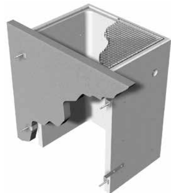
Befestigung bei gedämmten Kellerwänden
