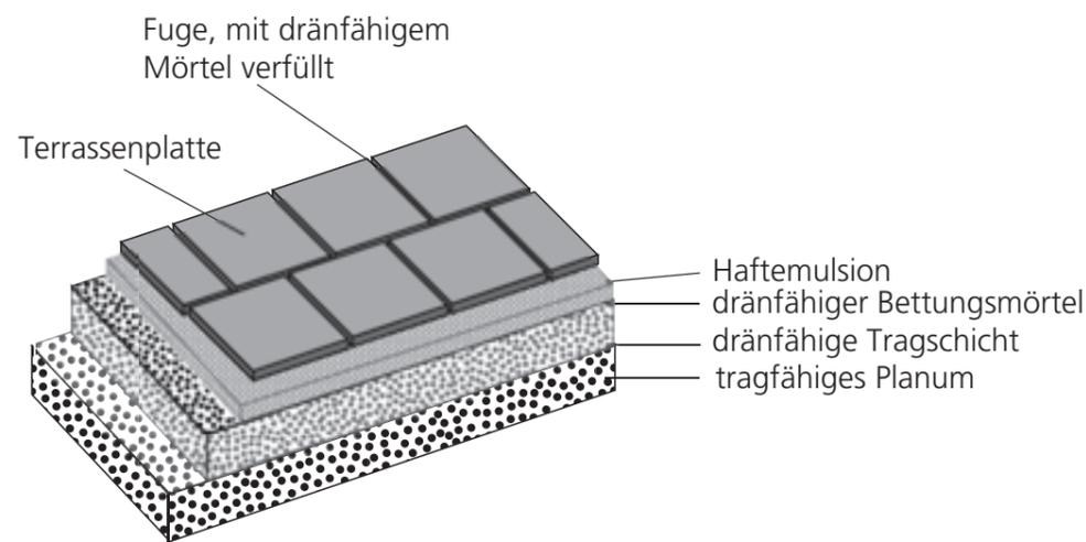
Schematischer Aufbau eines Terrassenplattenbelags (lose Verlegung)
