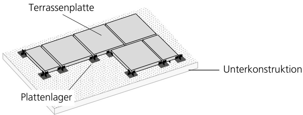
Schematischer Aufbau eines Terrassenbelags auf gebundener Tragschicht (feste Verlegung)
