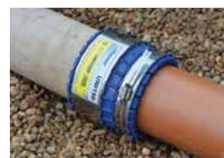
Die Rohrverbindung über die UNICON ist sicher hergestellt, sobald auch das schmale Spannband mit dem angegebenen Drehmoment angezogen ist.
