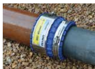
Die Rohrverbindung über die UNICON ist sicher hergestellt, sobald auch das schmale Spannband mit dem angegebenen Drehmoment angezogen ist.
