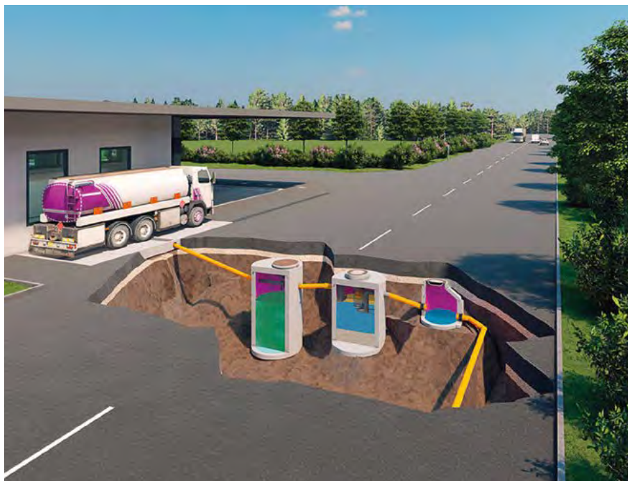
Die Auffangwanne unterhalb des LKW fängt Regenwasser und havarierte Flüssigkeiten beim Ab- oder Umfüllprozess auf und leitet diese durch oder in den FUCHS Presidio, den FUCHS Abscheider und den Probenahmeschacht
