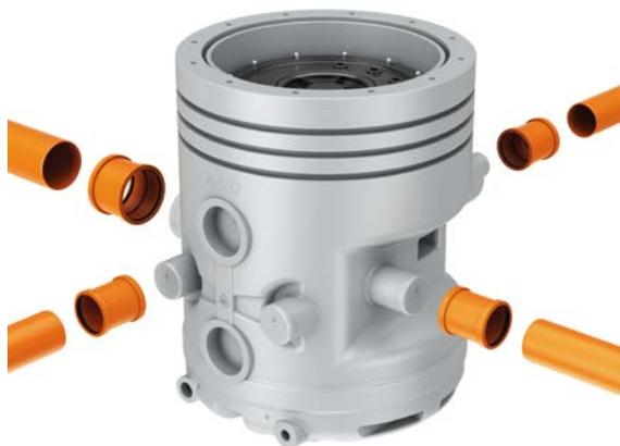
Der Grundkörper aus Polyethylen besitzt sieben verteilte Zuläufe für den Anschluss von Kunststoffrohren mit Außendurchmessern 110 oder 160 mm. Zum einfachen Anschluss von im Keller verteilten Entwässerungsgegenständen sind diese Zuläufe auf verschiedenen Höhenniveaus rund um den Grundbehälter verteilt.
