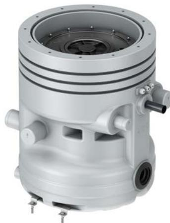
Mit der Überflur-Variante der Hebeanlage Multi-Flex steht eine Ausführung zur Aufstellung im Raum oder zur Montage in einem entsprechend großen bauseitigen Schacht zur Verfügung. Der Zugang zur Pumpeinheit für Inspektion und Wartung erfolgt über einen geruchsdicht verschlossenen Deckel von oben.
