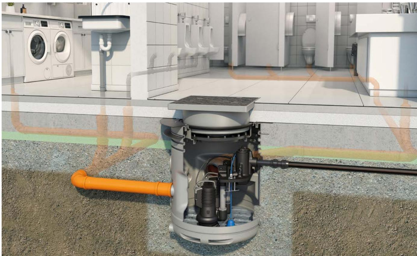
**Punktet mit modularer Flexibilität: ACO Multi-Flex für fäkalienfreies und fäkalienhaltiges Abwasser zur Unterflurinstallation oder zur Freiaufstellung**
