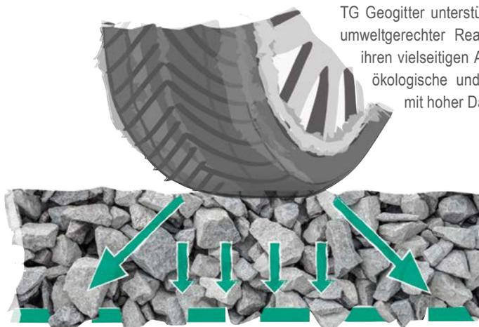
**Verzahnungseffekt und Plattenwirkung bei ungebundenen Tragschichten:**
