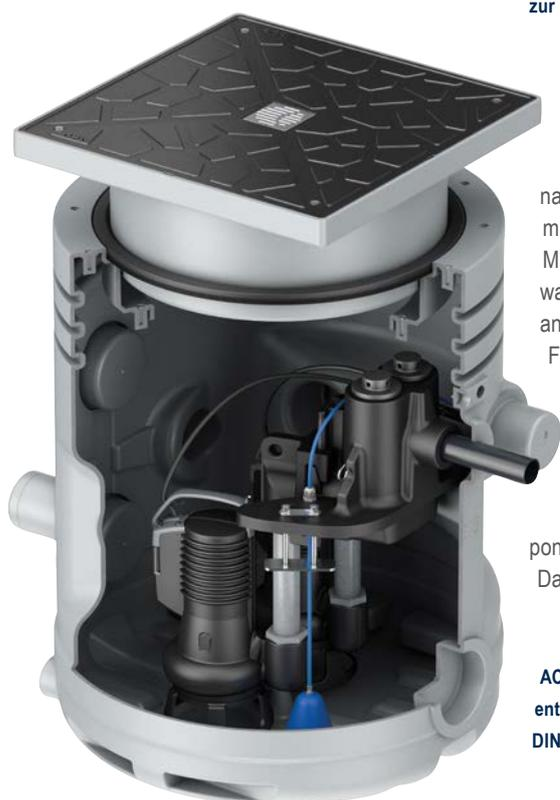
Eine Pumpstation bzw. Abwasserhebeanlage ist erforderlich, wenn Schmutzwasser unterhalb der Rückstauenebene anfällt und nach oben gepumpt bzw. gehoben werden muss, um in die Kanalisation zu gelangen. Mit der neuen Multi-Flex präsentiert der Abwasserspezialist ACO Haustechnik eine Hebeanlage, deren modularer Aufbau besondere Flexibilität bei der Aufstellung bereithält. Ihr Anwendungsbereich sind Mehrfamilienhäuser, Bürogebäude, Industriegebäude, Waschküchen und Technikräume.
